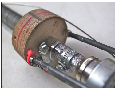
Détail d'un actionneur linéaire ancienne génération
