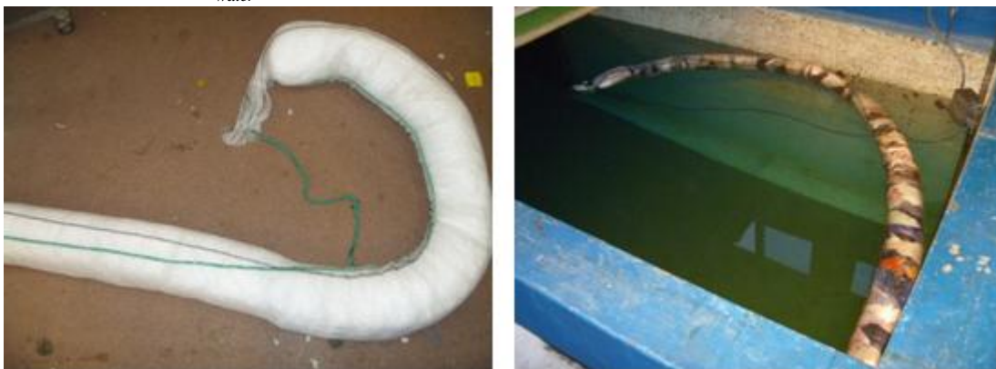
Figuur 6.2: Staart gevuld met polypropyleen (links), De staart gevuld met mengsel van katoen en polypropyleen op de juiste diepgang (rechts).
