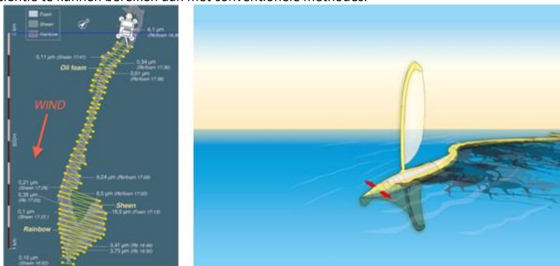
Figuur 2.1: De aan de windse koers van de Protei voorgesteld door de gele lijn (links) en een impressie van hoe de Protei er uit kan gaan zien (rechts). [1]
